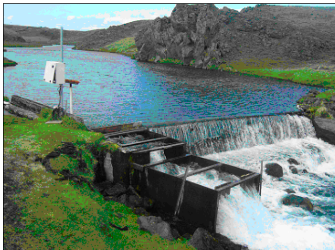
Fiskteljari í Grenlæk, við rafstöðvarstíflu í landi Seglbúða. Fiskteljari hefur verið starfræktur í Grenlæk frá árinu 1996.
